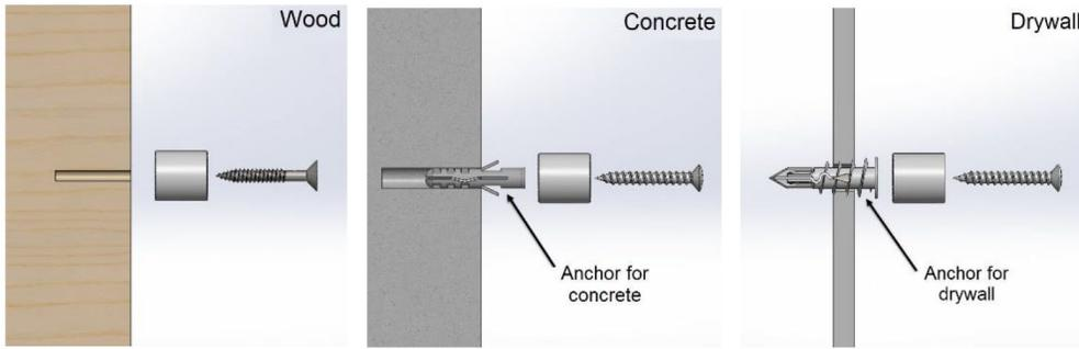
Siempre revisa la superficie sobre la cual se va a instalar y asegúrate que tenga la suficiente resistencia para soportar el peso del letrero. Todas las instalaciones deben hacerse con las herramientas correctas.
